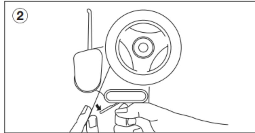
2 Retirez l'avant du ruban à travers la fente entre le rouleau dérouleur et la guide métallique.
