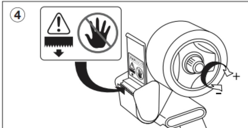
4 Tirez le ruban pour qu'il se trouve au-dessus la barre de coupe / lame dentelée, en faisant attention à ne pas vous couper sur la lame tranchante.
