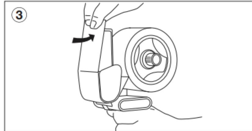
3 Réglez la tension du distributeur (au centre de la roue grande) pour que le mécanisme de déroulement fonctionne confortablement et en douceur. ATTENTION: La lame est aiguisée, faites donc attention pendant le chargement, réglage de tension et utilisation.
